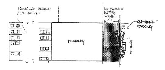
FIGURE 1. RECOMMENDED ON-SITE PARKING LOCATION
